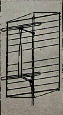
„Varia 1“, eine Einebenen-Antenne für hohe Ansprüche. Links daneben: „Recta-R“, ein verkürzter Dipol mit Kanal-Anpaßschleife
