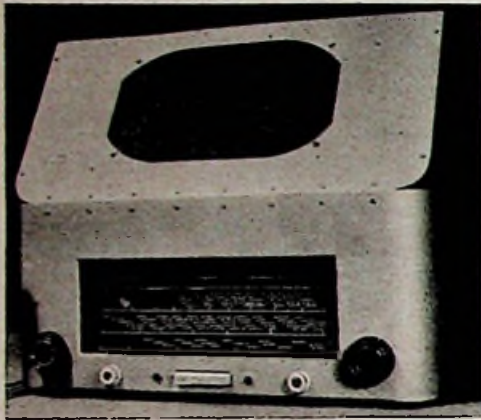
Das in ein neues Gehäuse eingebaute Rundfunkgerät für die Betriebslautsprecheranlage
