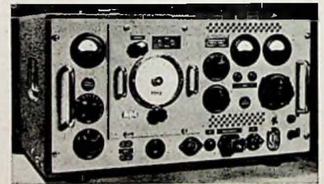
Feldstärkemeßgerät (Funkwerk Dresden)
