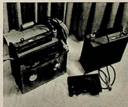
Reportermagnetophon „Reporto-Ton“ im Aktentaschenformat (Beyco); links: Koffer-Magnettongerät „5401/19“ (Flohr); rechts: Blick auf das in einer Truhe eingebaute „Dimafon“ (Dittmar)
